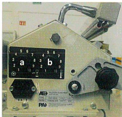
Figura 1. Botones de regulación de la Maquina Audion MAGNETA 1020:
