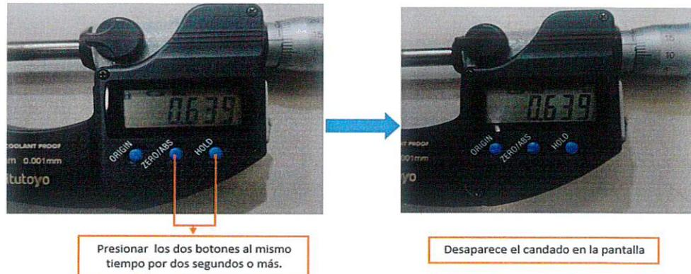
Figura 8. Desbloqueo de funciones ZERO/ABS y HOLD
